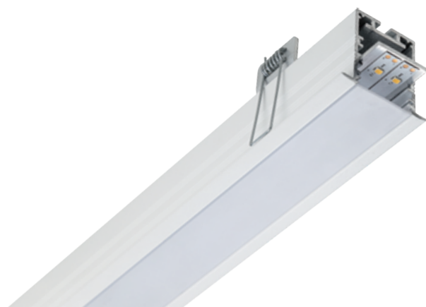
profilo dissipatore posizionabile a diverse altezze per una maggiore o minore emissione luminosa (max 30W/mt). aluminium heatsink profile to be fixed in two slots allowing more or less light emission (max 30W/mt).
