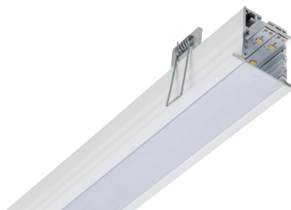
profilo dissipatore posizionabile a diverse altezze per una maggiore o minore emissione luminosa (max 30W/mt). aluminium heatsink profile to be fixed in two slots allowing more or less light emission (max 30W/mt).
